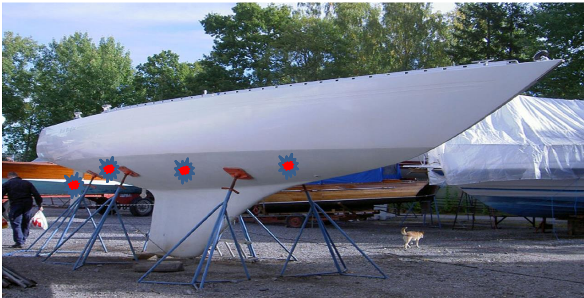
Figur 1. Mätpunkter på båtar mätta av Happy Boat AB. Mätningar utfördes 10-30 cm nedanför vattenlinjen på både styrbord och babord sida enligt bilden (styrbord bak, styrbord mitt, styrbord för, babord för, babord mitt och babord bak plus ömse sidor av rodrät). På motorbåtar utan roder mättes på akterspegeln eller drevstocken.
